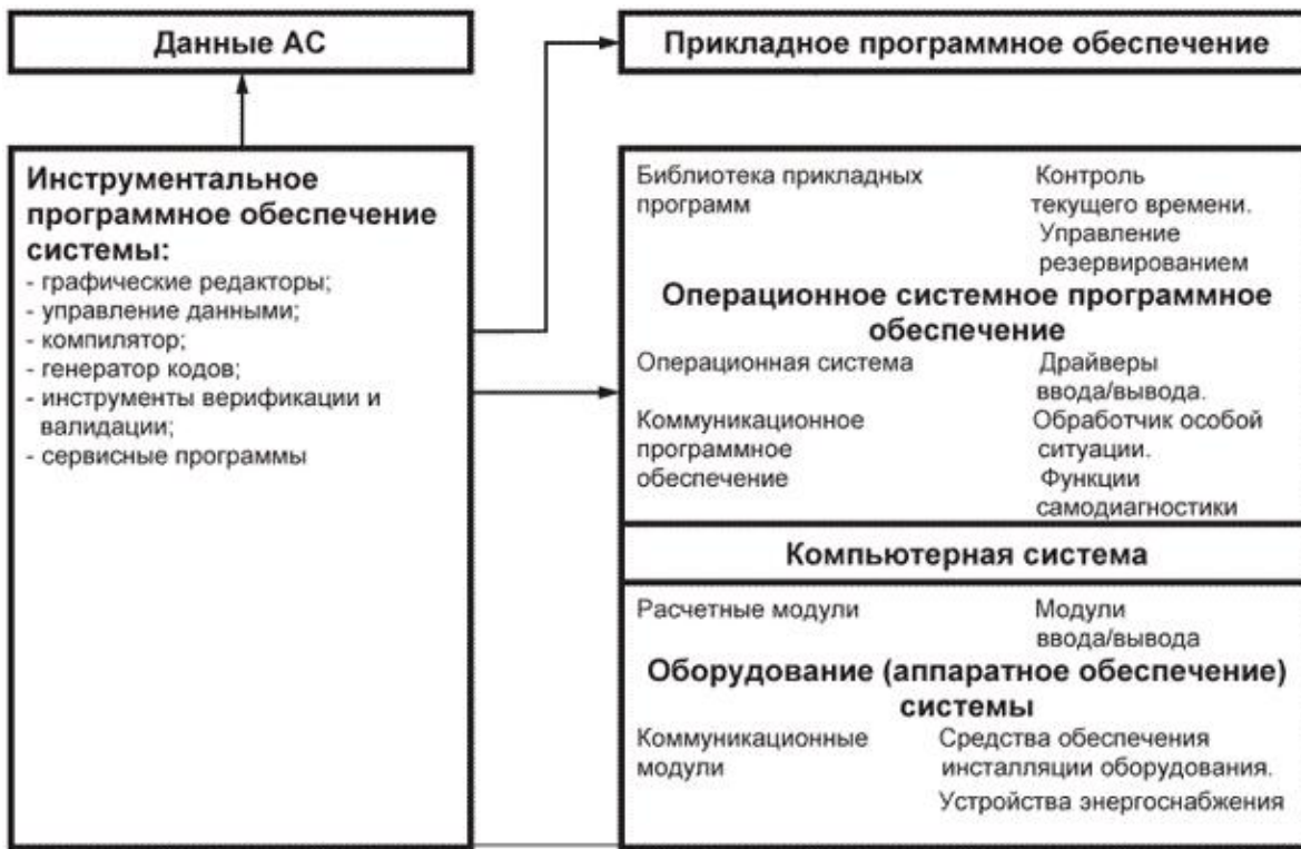
Рисунок 2 - Характерные взаимосвязи между аппаратными и программными средствами компьютерных систем
