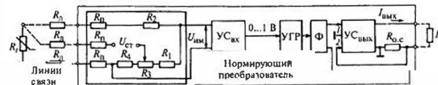
Рис. 7.12. Структурная схема нормирующего преобразователя для ТС
