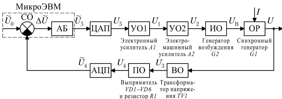
Рис. Д.5. Функциональная схема цифровой САР напряжения генератора
