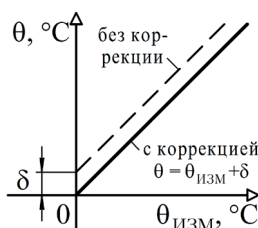
Рис. Д.31. Совмещенные статические характеристики измерительного тракта регулятора ТРМ
